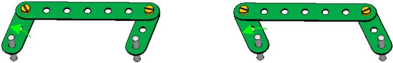
Figure 4 : pantographe mis en mouvement
